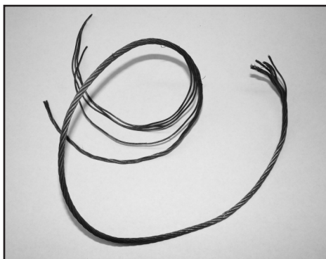
Écrasement et déformation du câble
